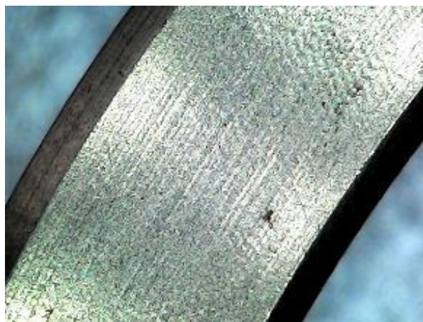
Рисунок 2 - Структура поверхні бронзової втулки до віброшліфування та після віброшліфування.
