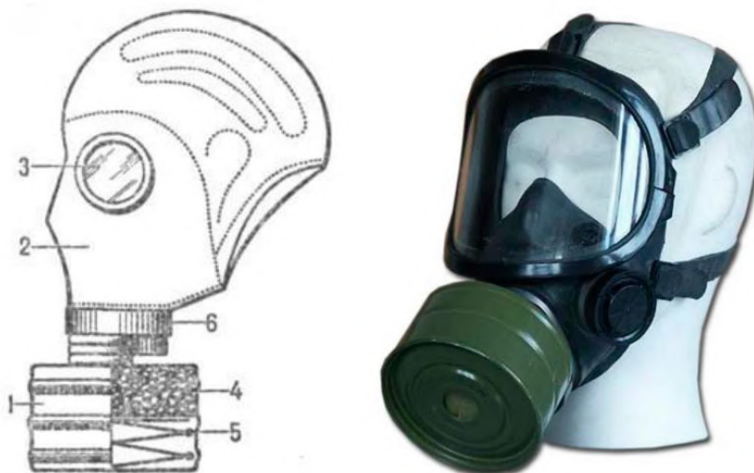
Рис. 1. Фільтруючий протигаз. 1- фільтруюча поглинальна коробка; 2 - лицьова частина; 3 - очковий вузол; 4-шихта; 5-ПАФ; 6-клапанна коробка.
